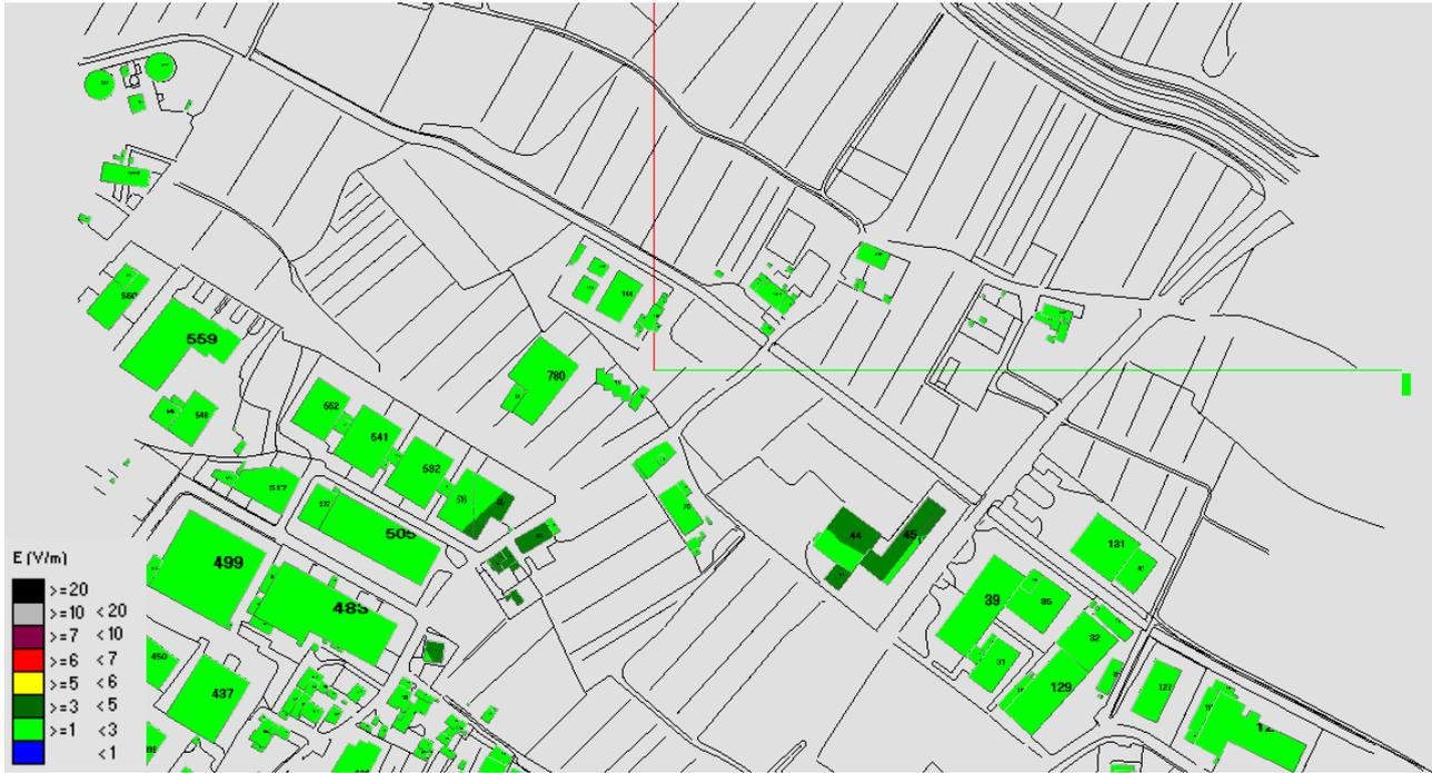
Fig. 18 Impatto elettromagnetico – Zona Area Ex Macelli – Vista dall'alto
