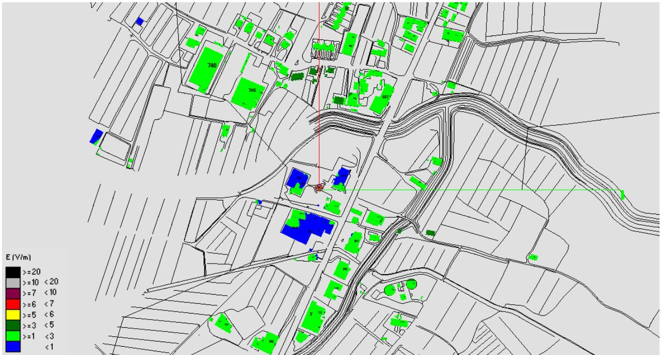
Fig. 12 Impatto elettromagnetico –Zona Torre Acquedotto – Vista dall'alto
