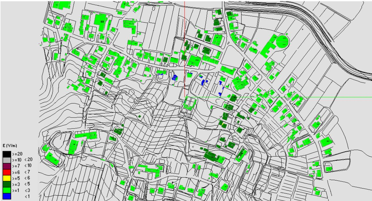
Fig. 6 Impatto elettromagnetico – Zona Cimitero Valenzatico – Vista dall'alto
