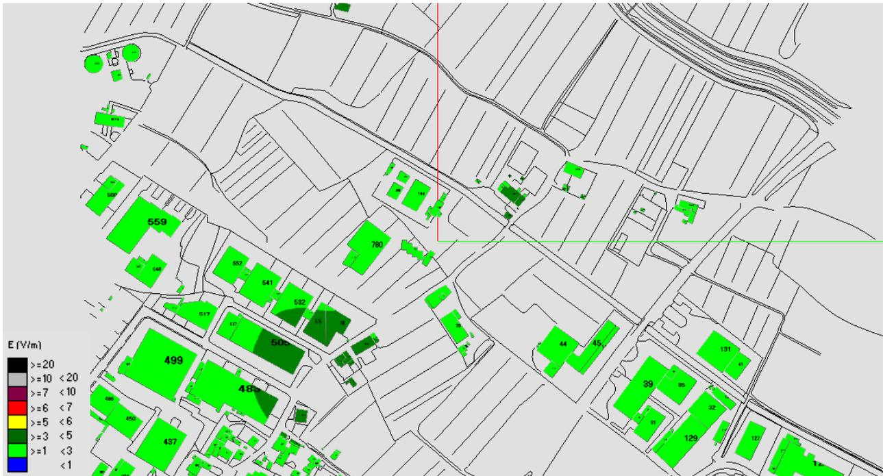
Fig. 21 Impatto elettromagnetico – Zona Area Ex Macelli e Cantiere Comunale – Vista dall'alto
