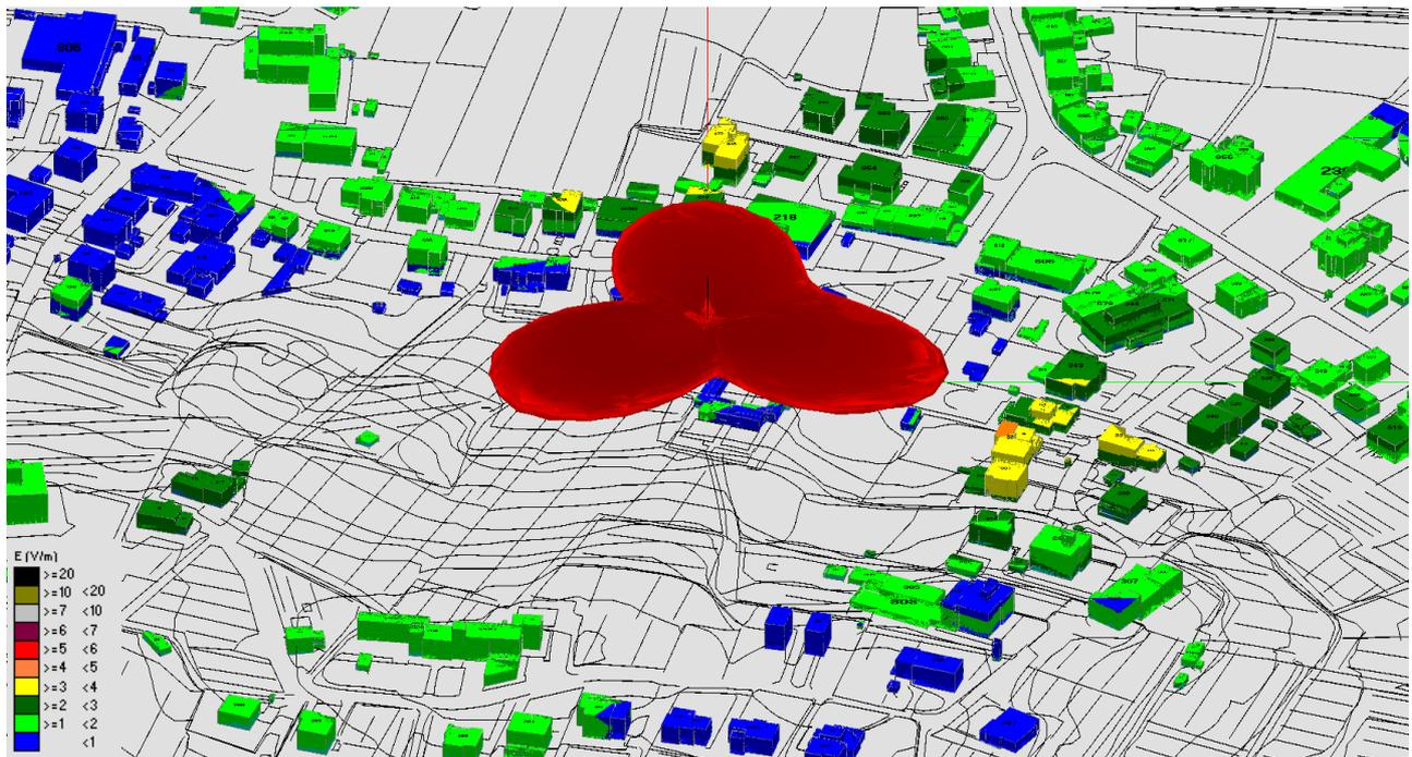
Fig. 4 Impatto elettromagnetico – Zona Cimitero Valenzatico – 0°/Nord
