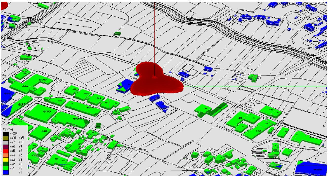
Fig. 10 Impatto elettromagnetico – Zona Ex Macelli – 0°/Nord
