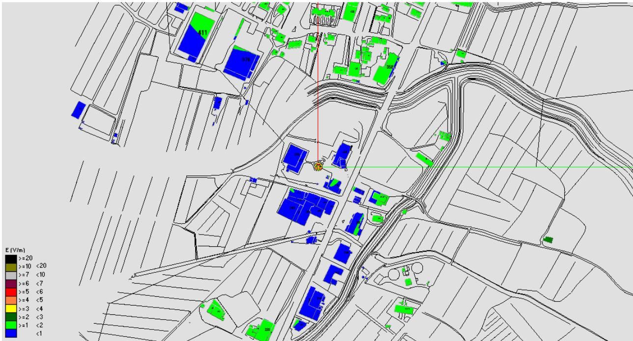
Fig. 8 Impatto elettromagnetico – Zona Torre Acquedotto – Vista dall'alto
