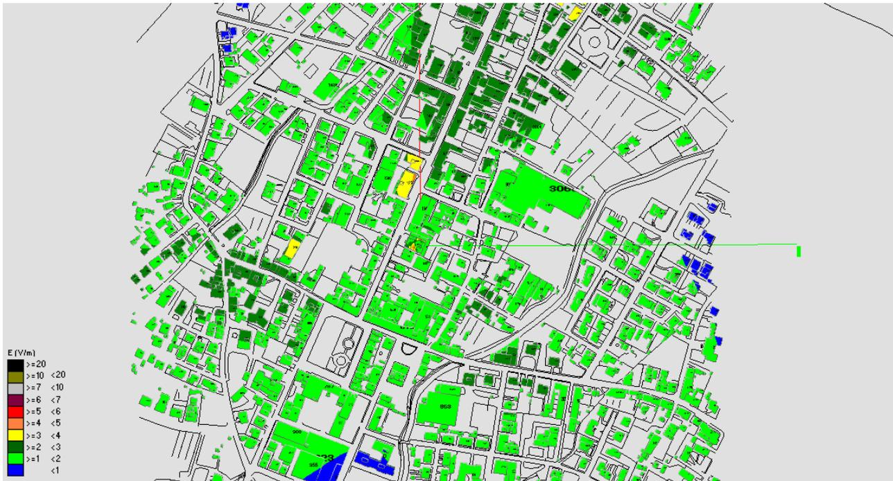
Fig. 17 Impatto elettromagnetico – Zona Via Mazzini – Vista dall'alto
