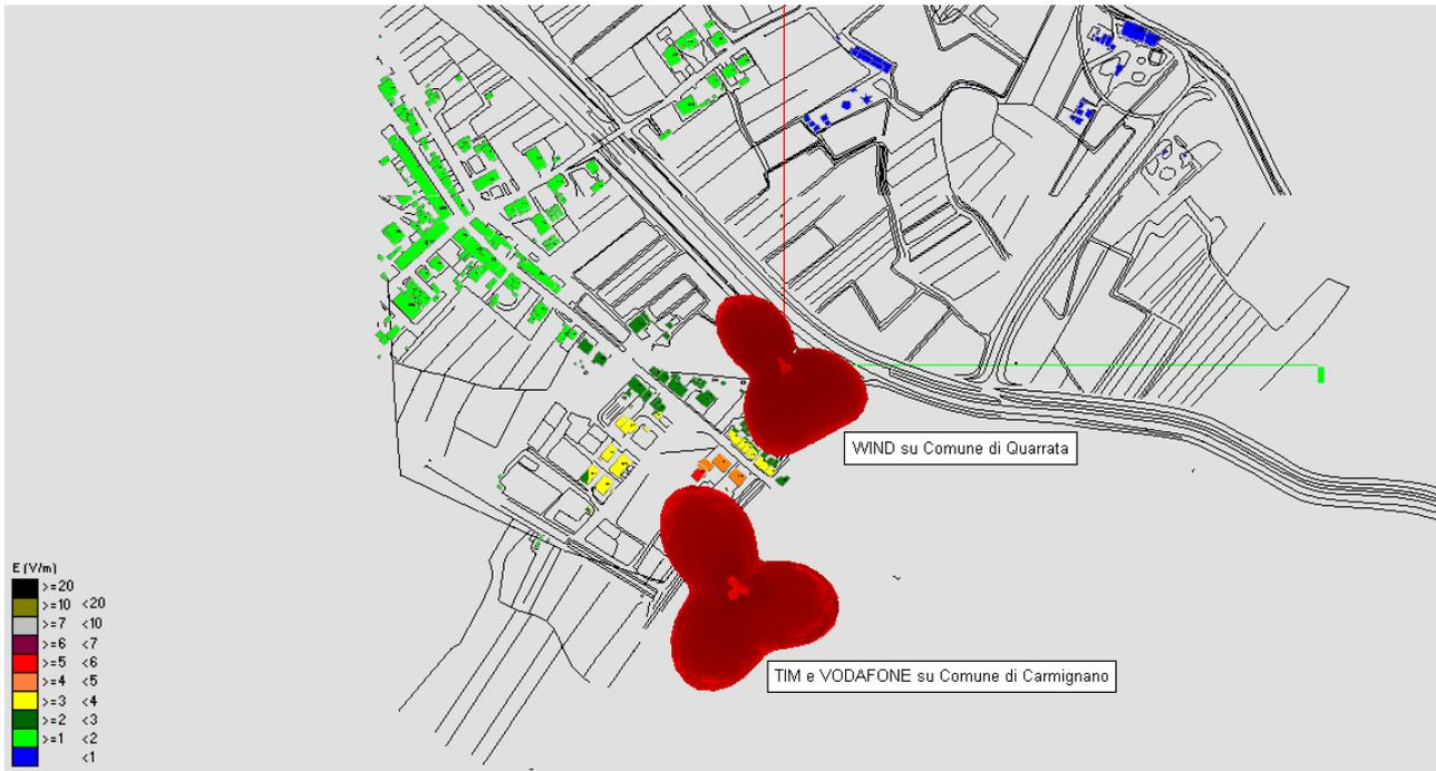
Fig. 26 Impatto elettromagnetico - Zona Depuratore Via SS Pistoiese - conf Carmignano - Vista dall'alto
