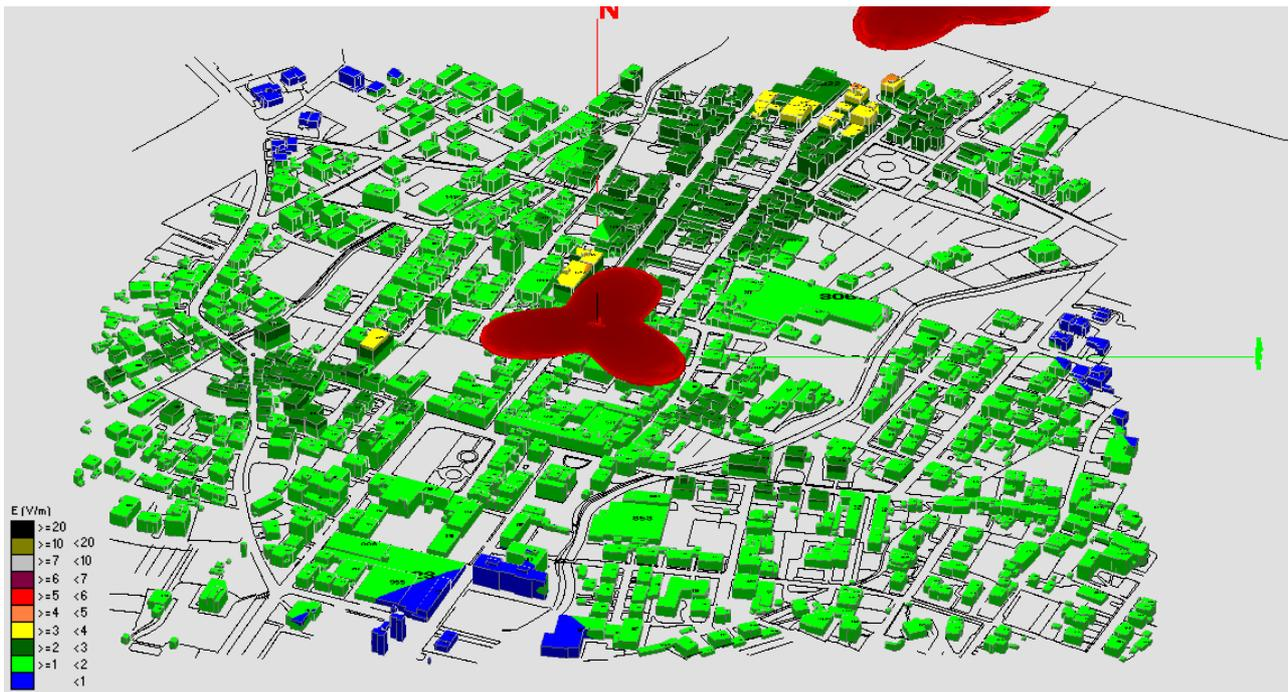
Fig. 16 Impatto elettromagnetico – Zona Via Mazzini – 0°/Nord
