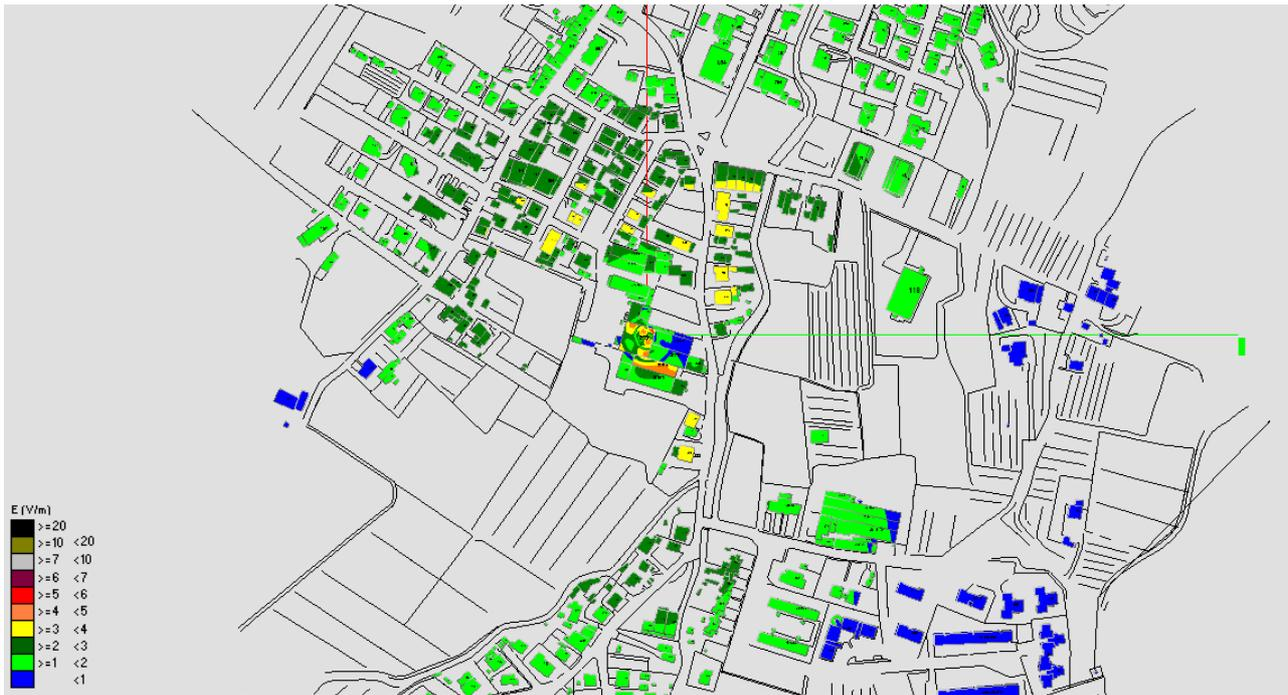
Fig. 23 Impatto elettromagnetico – Zona Via Mascagni – Vista dall'alto
