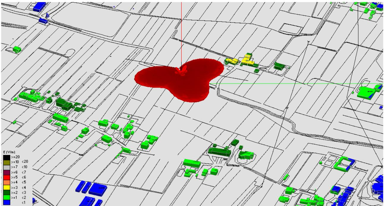
Fig. 1 Impatto elettromagnetico – Zona Olmo – 0°/Nord
