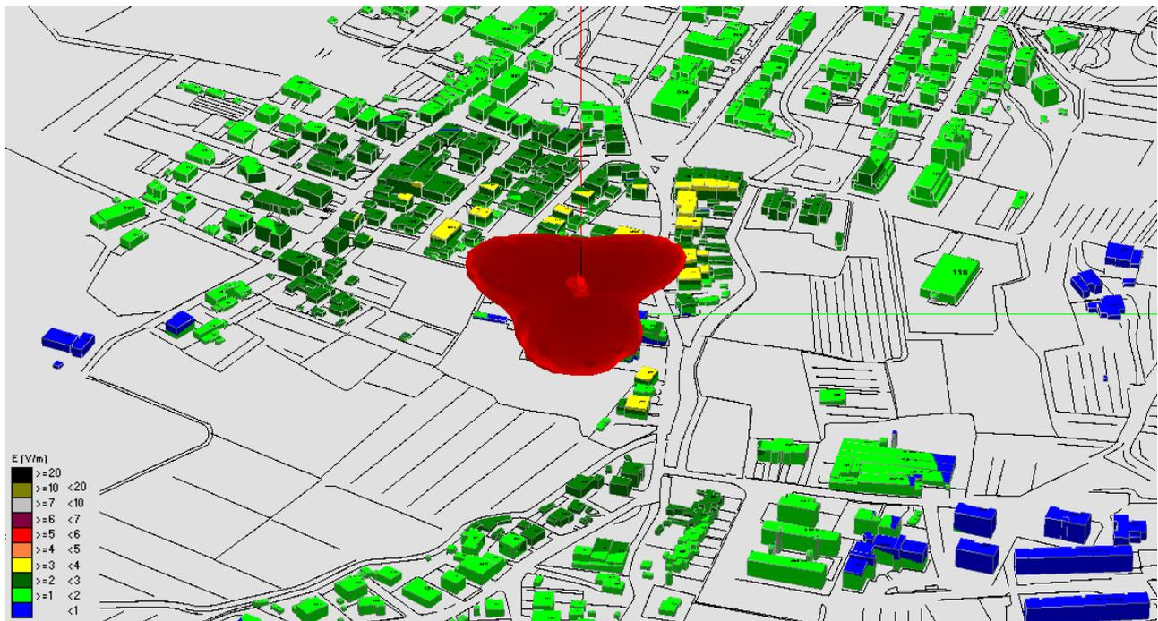
Fig. 22 Impatto elettromagnetico – Zona Via Mascagni – 0°/Nord
