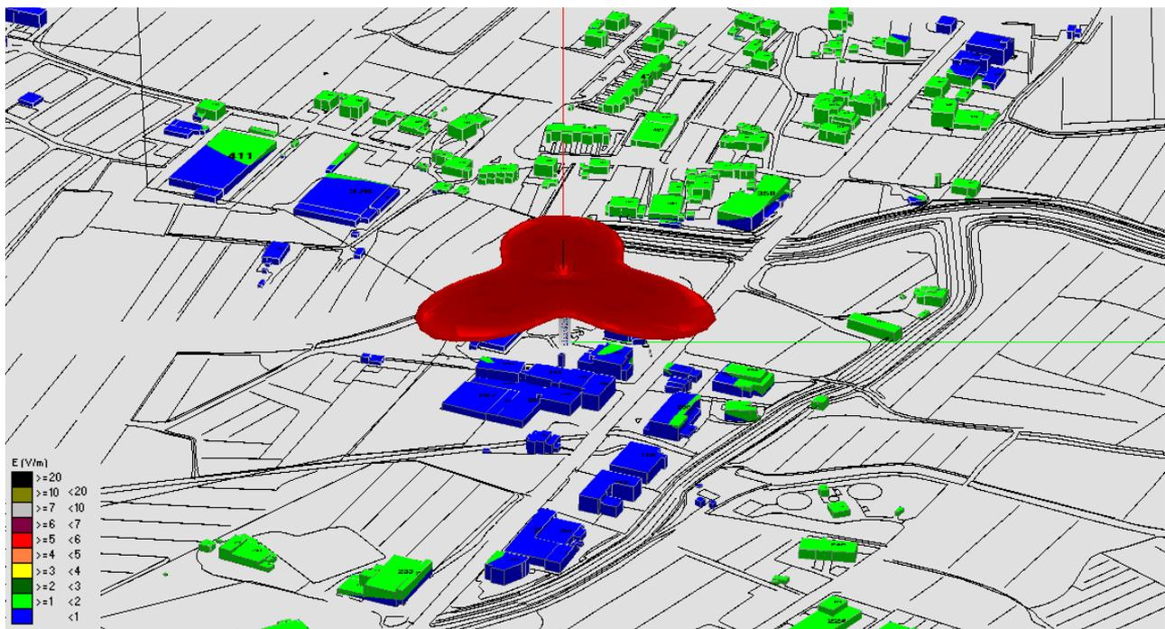
Fig. 7 Impatto elettromagnetico – Zona Torre Acquedotto – 0°/Nord
