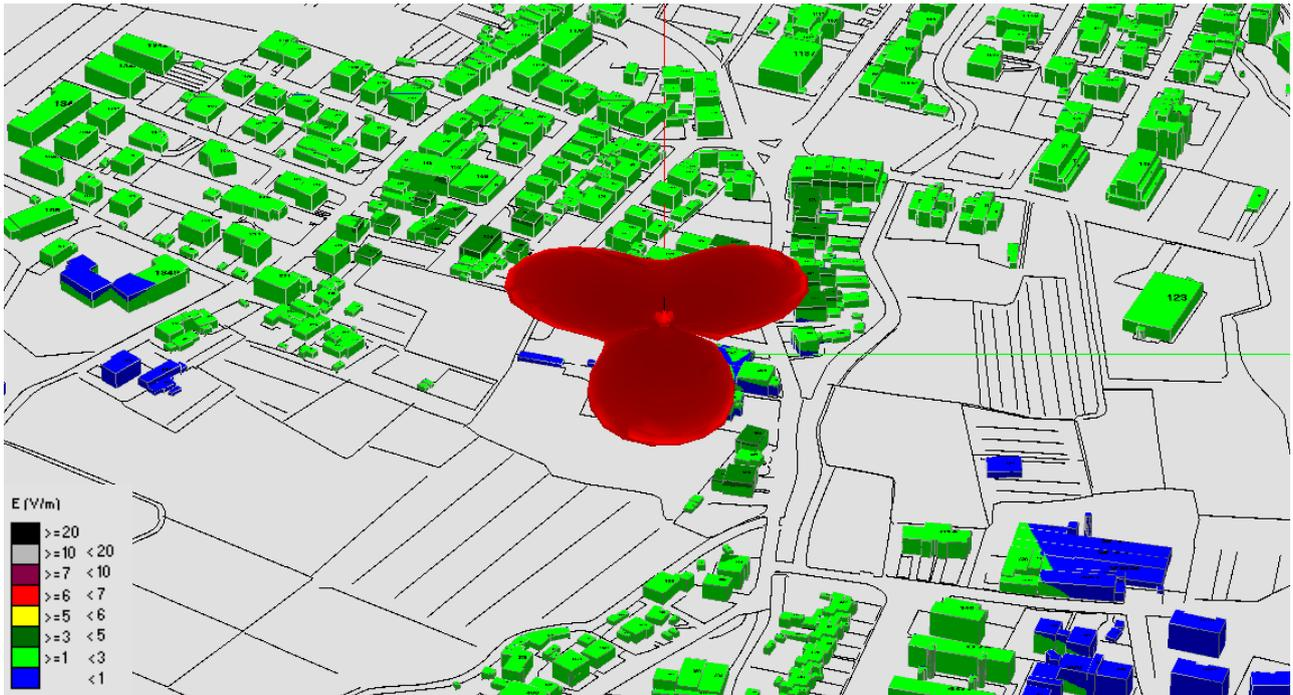
Fig. 32 Impatto elettromagnetico – Zona Via Mascagni – 0°/Nord
