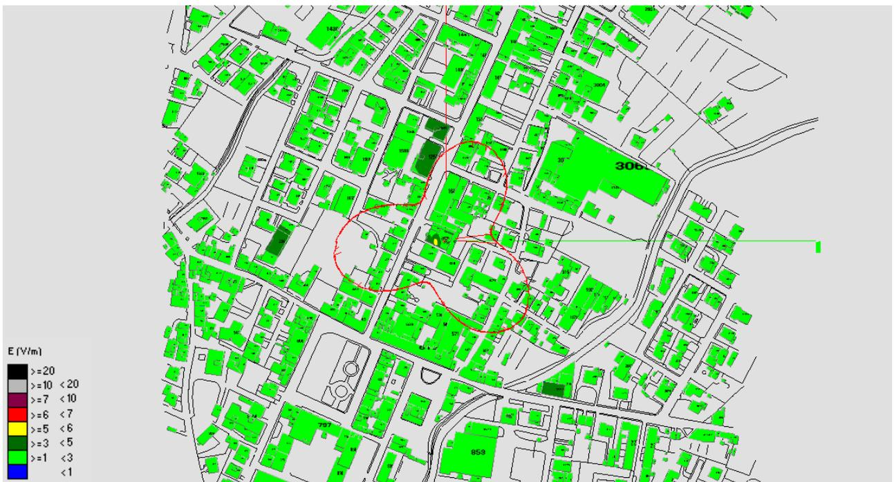
Fig. 28 Impatto elettromagnetico – Zona Via Mazzini – Vista dall'alto
