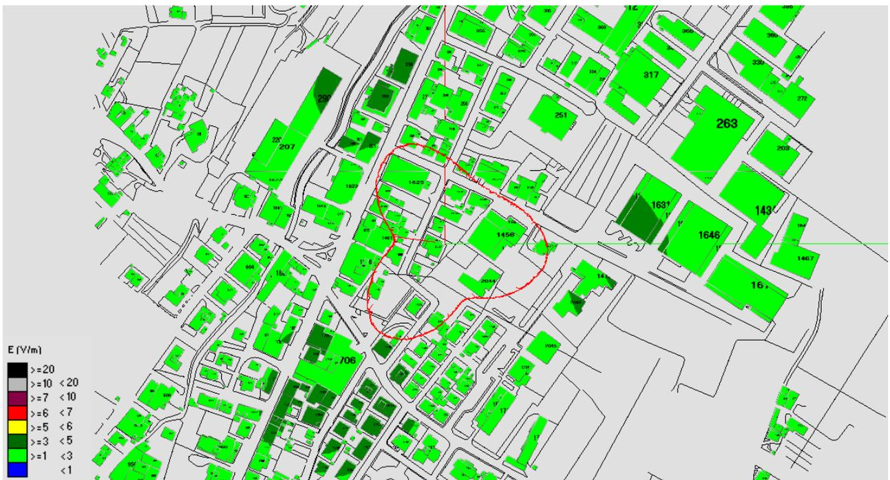
Fig. 23 Impatto elettromagnetico – Zona Centrale Telecom Via Tiziano – Vista dall'alto
