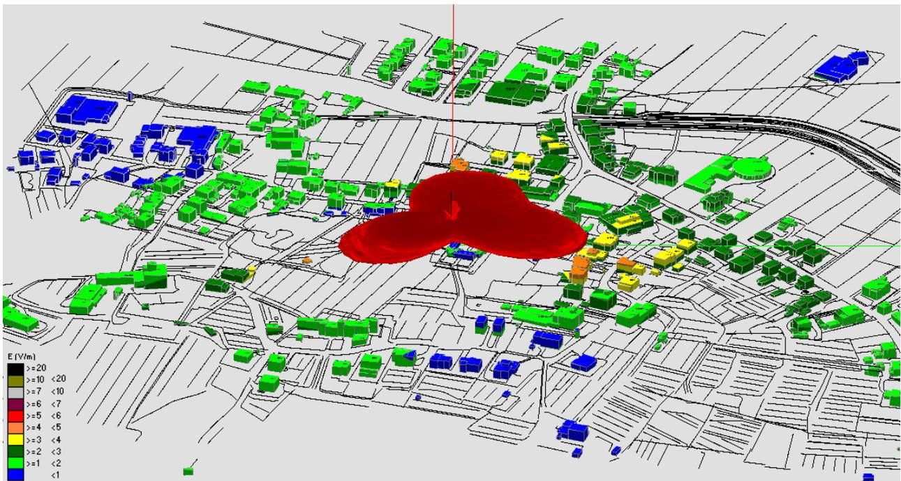
Fig. 4 Impatto elettromagnetico – Zona Cimitero Valenzatico – 0°/Nord
