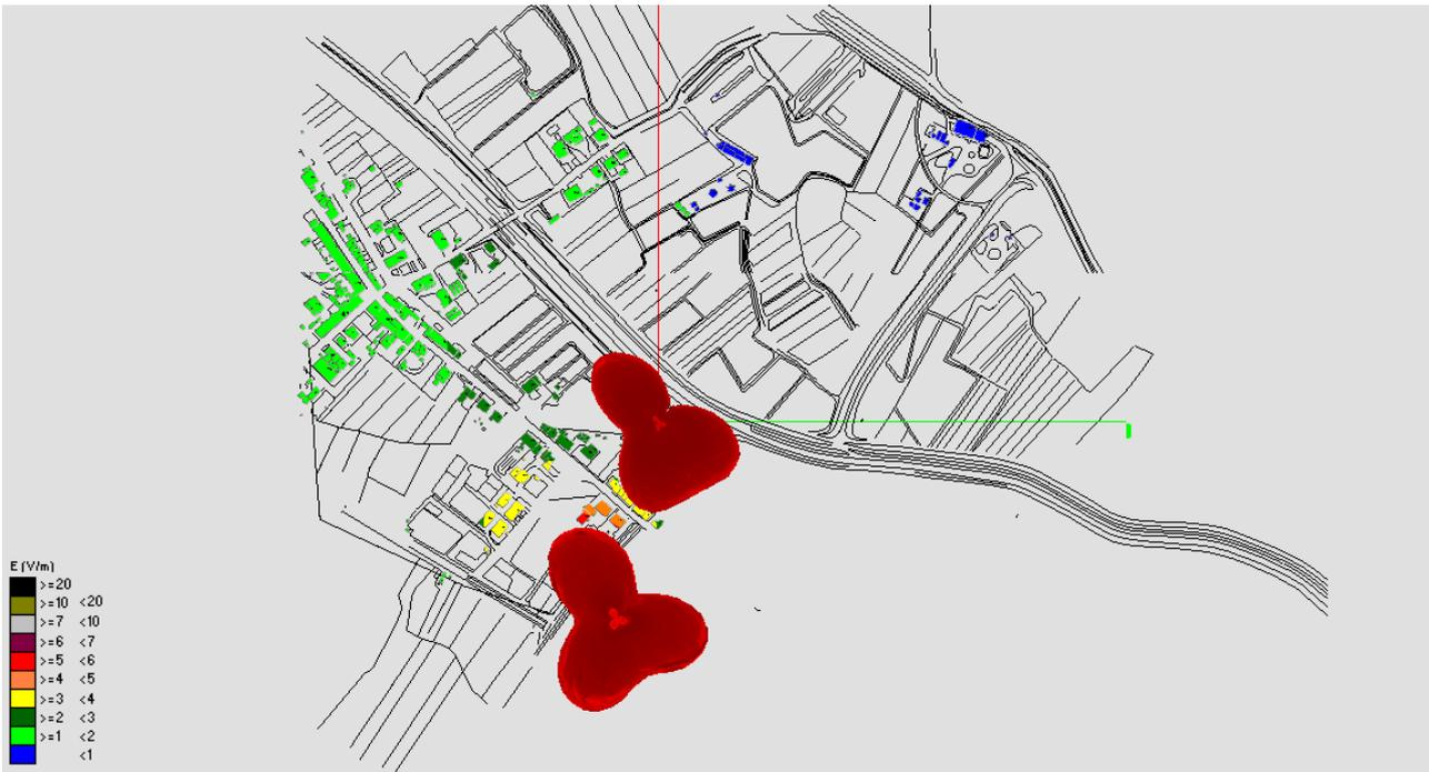
Fig. 29 Impatto elettromagnetico - Zona Depuratore Via SS Pistoiese - conf Carmignano - Vista dall'alto
