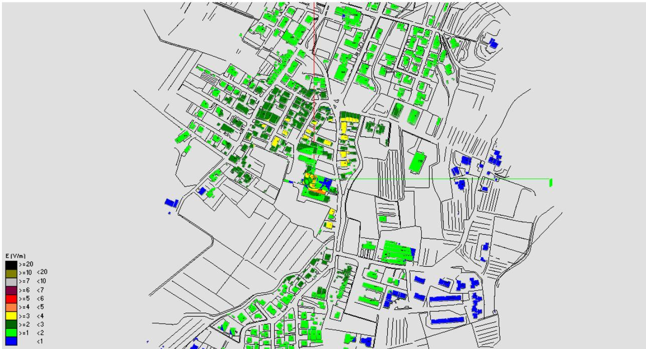
Fig. 26 Impatto elettromagnetico – Zona Via Mascagni – Vista dall'alto
