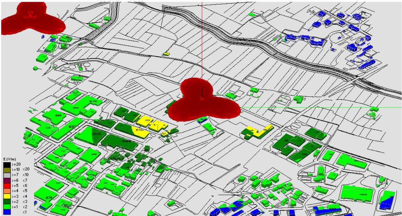
Fig. 13 Impatto elettromagnetico – Zona Ex Macelli – 0°/Nord
