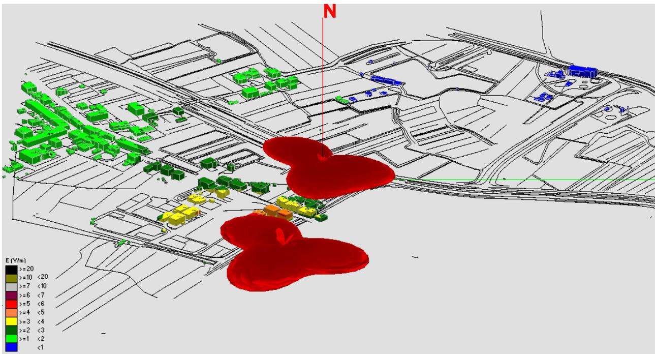
Fig. 28 Impatto elettromagnetico - Zona Depuratore Via SS Pistoiese - conf Carmignano - 0°/Nord
