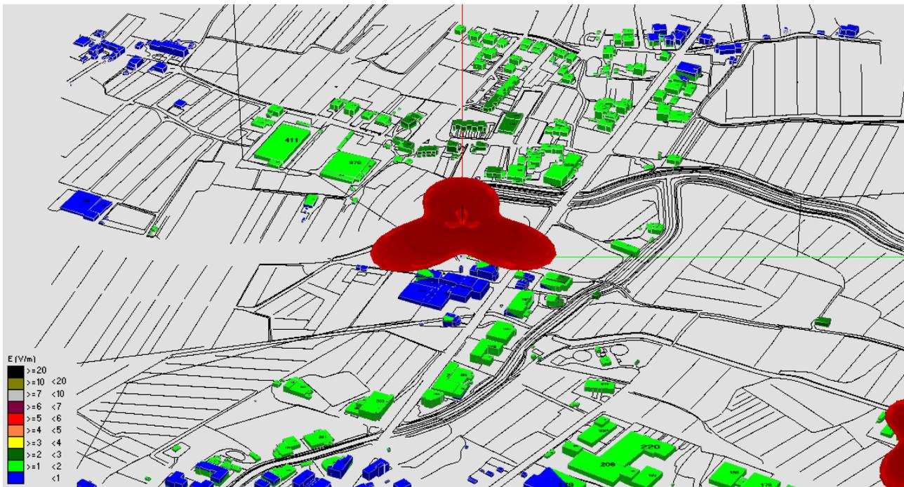
Fig. 10 Impatto elettromagnetico – Zona Torre Acquedotto – 0°/Nord
