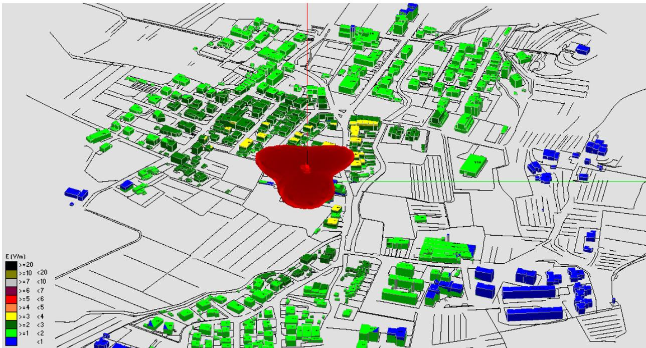
Fig. 25 Impatto elettromagnetico – Zona Via Mascagni – 0°/Nord
