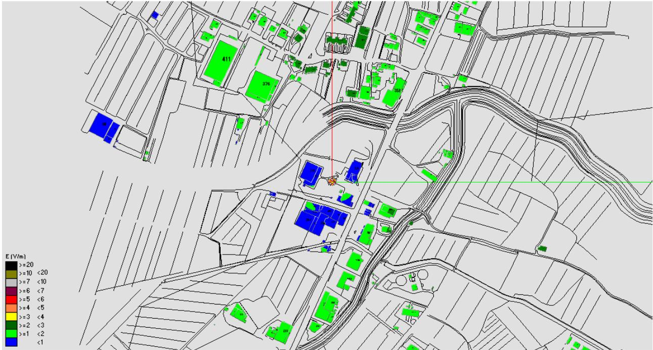
Fig. 11 Impatto elettromagnetico – Zona Torre Acquedotto – Vista dall'alto
