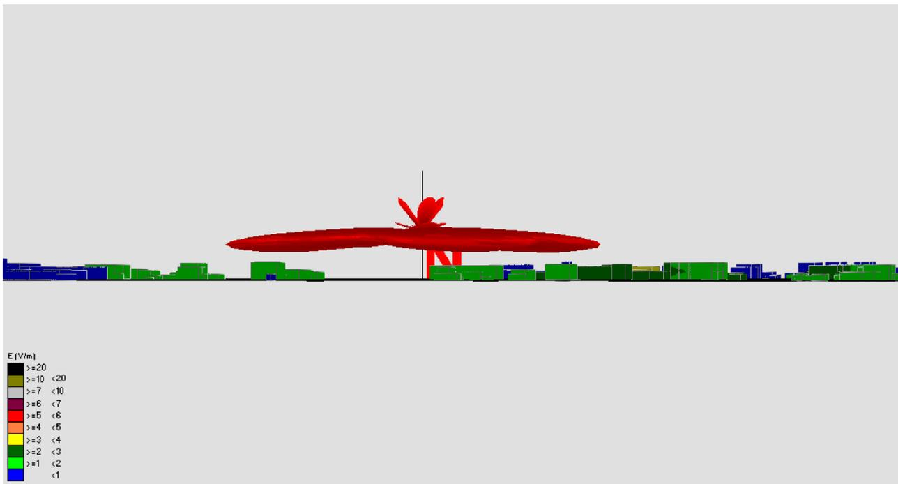
Fig. 3 Impatto elettromagnetico – Zona Olmo – Vista Laterale
