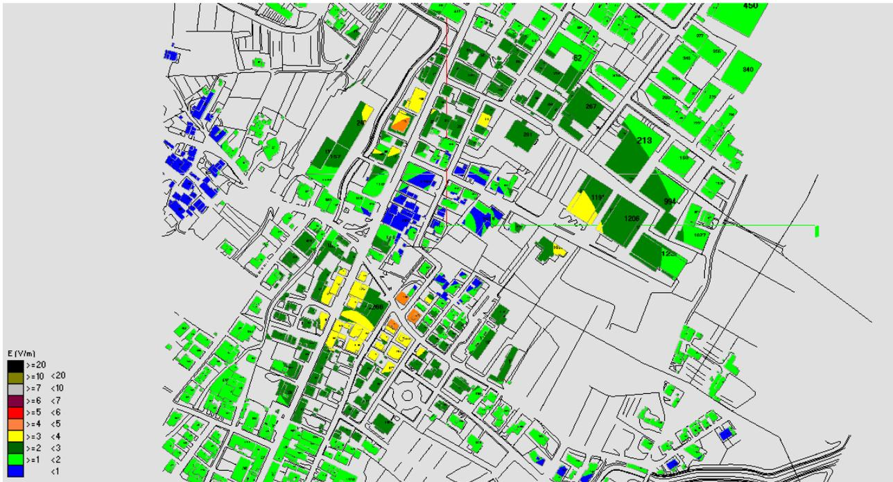
Fig. 17 Impatto elettromagnetico – Zona Centrale TELECOM Via Tiziano – Vista dall'alto
