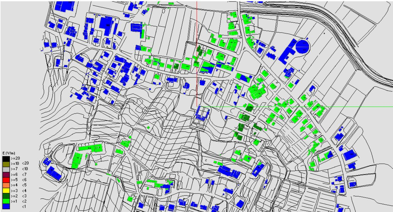
Fig. 5 Impatto elettromagnetico – zona Cimitero Valenzatico – Vista dall'alto
