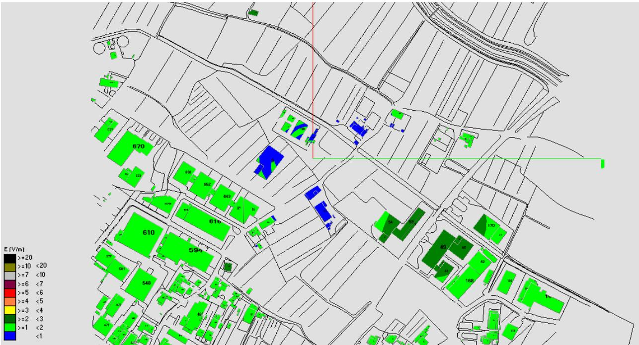
Fig. 11 Impatto elettromagnetico – zona Ex Macelli – Vista dall'alto
